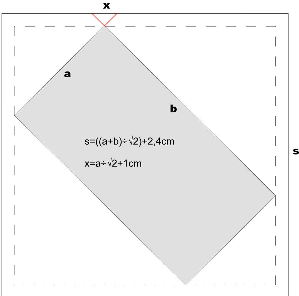
**Bitte die Stanzungen und Falzungen für x nur einmal beim errechneten Maß ausführen und dann nach der Falzlinie richten...**
